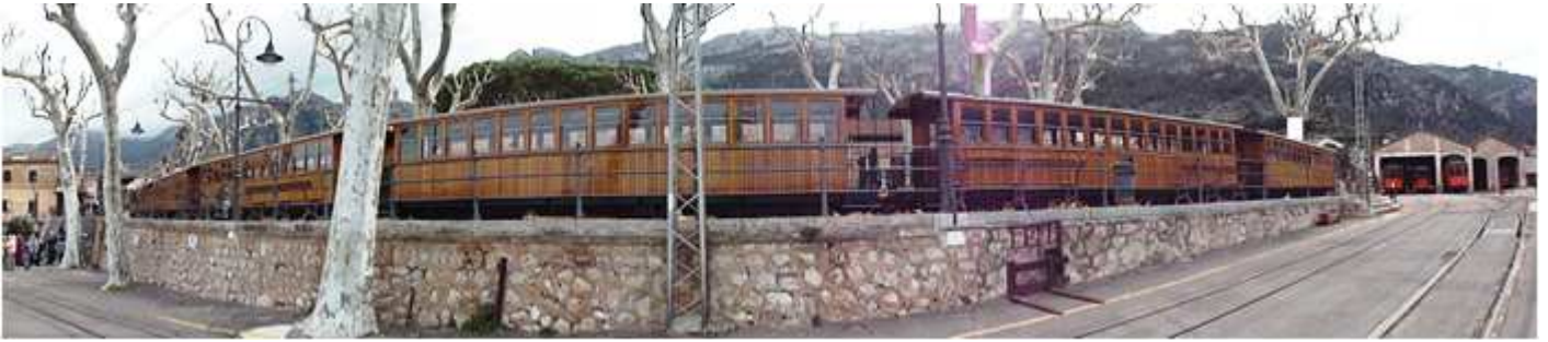
1 Andén con el convoy de vagones, esta línea dispone del ancho inglés. 914 mm (yarda inglesa).
