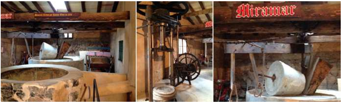
❶ Los distintos instrumentos y aperos de un molino. ❷ Máquina para prensar la aceituna molida. ❸ Molino y una tolva a la su derecha.
