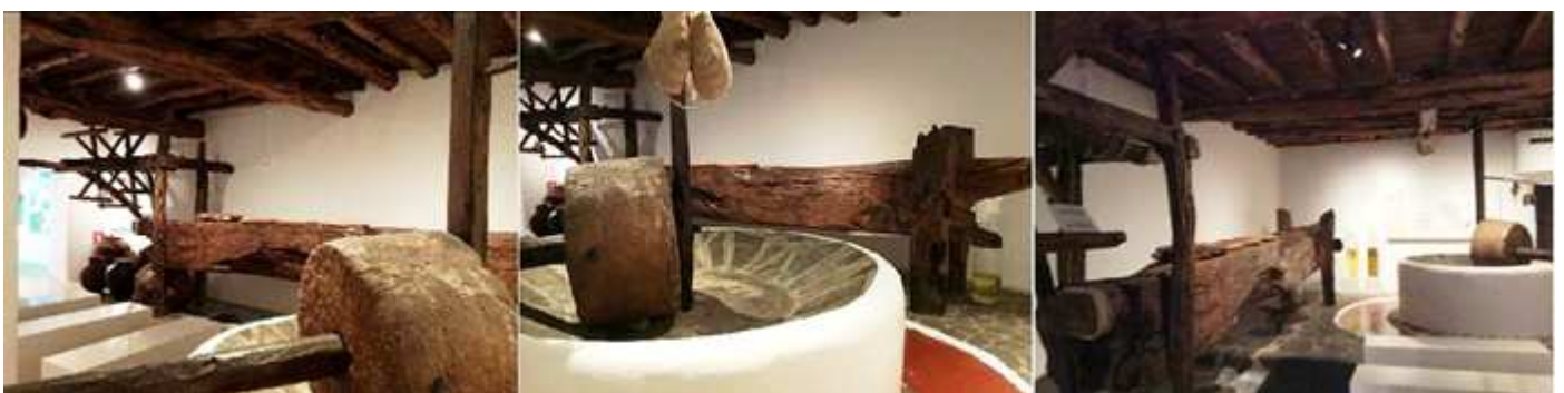
❶ Primer plano de la muela. ❷ Al fondo la prensa. ❸ Con estos artefactos se molía la aceituna y se prensaba filtrando el aceite.
